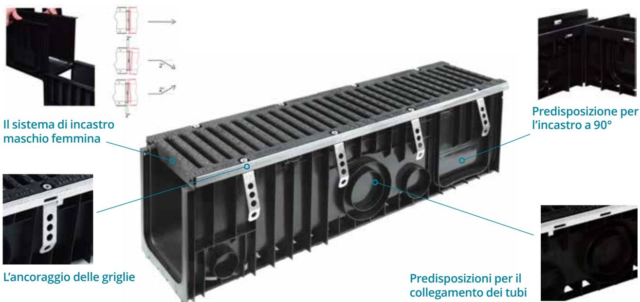
I canali SABdrain sono realizzati in PP (polipropilene), materiale che gode di una ottima resistenza meccanica ed agli sbalzi termici, il PP è immune ad agenti chimici ed atmosferici, acidi, sali alcali oli e benzine. Le caratteristiche del PP rendono la superficie del canale estremamente liscia, la bassa scabrezza superficiale favorisce lo scorrimento dell'acqua ed evita la formazione di depositi facilitandone la pulizia.
